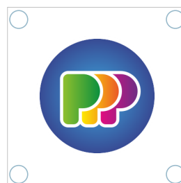
Boorgaten staan te dicht op de rand
